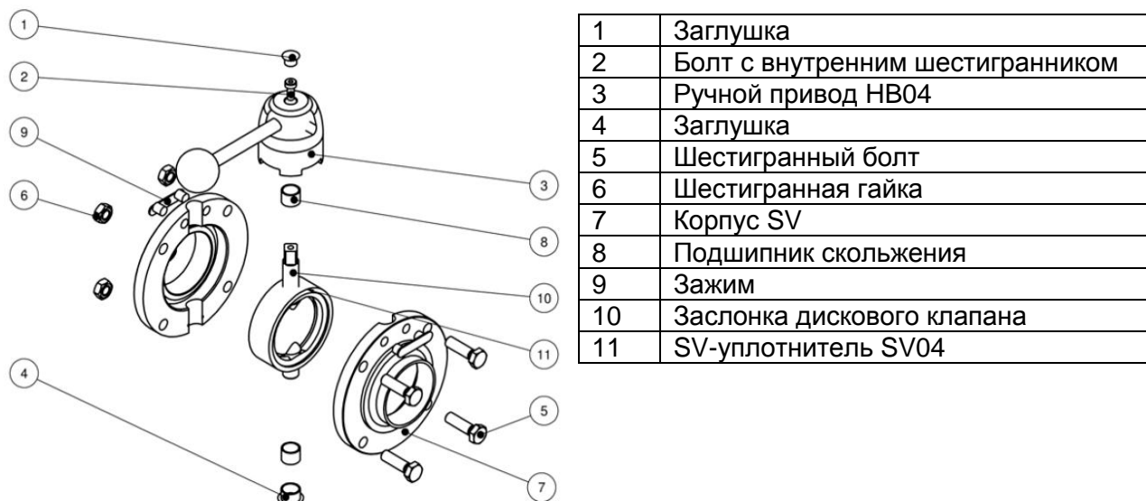
Рис. 14: Разбор дискового клапана SV04 с ручным приводом HB04
